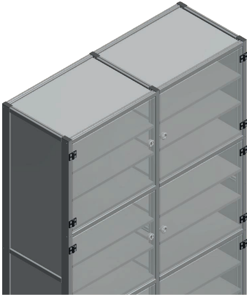
Stickstoffgefluteter Lagerkasten für Wafer
